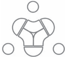
Configuration à trois faces Trois modules courbes 120 degrés, trois modules demi-cercle et trois modules circulaires
